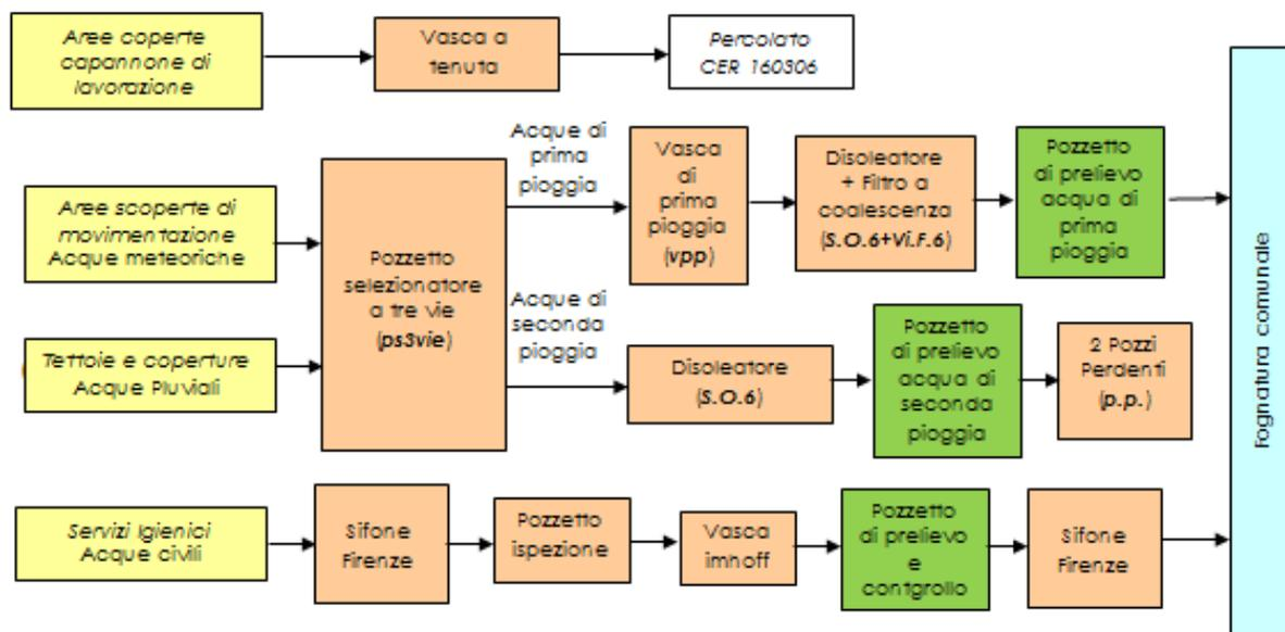
Il disoleatore è composto da una vasca di separazione oli e da una vasca con filtro a coalescenza sottoposta a controlli periodici.
